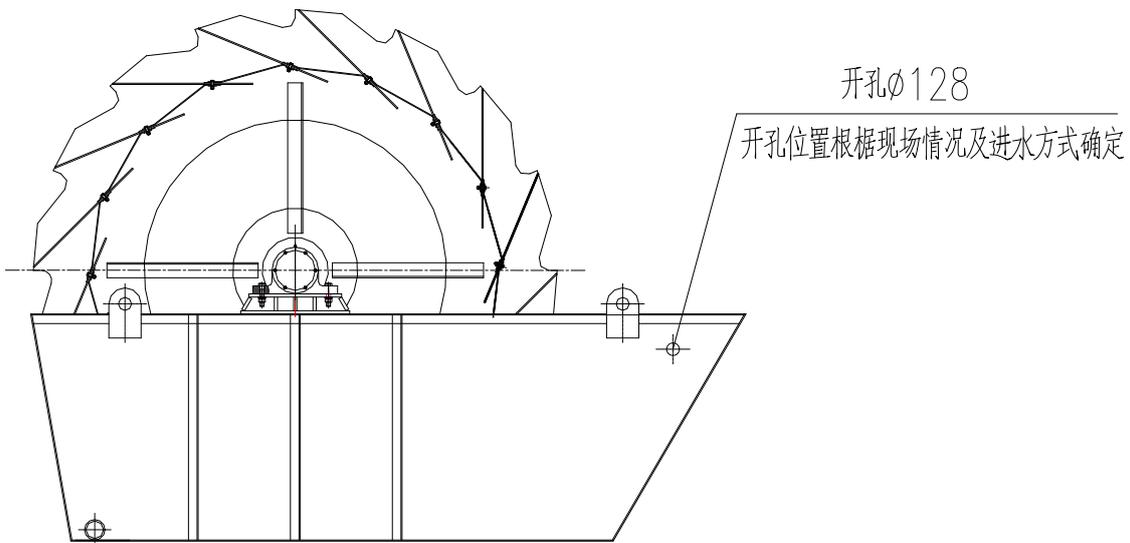
然后在壳体上焊接安装进水管（焊接及装配方式如图）。
